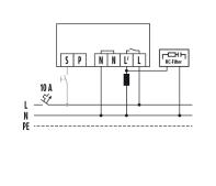
$Standard betrieb \ mit\ optionaler\ Ansteuerung\ durch\ Schließtaster\ und\ Verwendung\ von\ max.\ 10\ Slave-Ger\"{a}ten\ an\ einem\ Master-Ger\"{a}t.$
