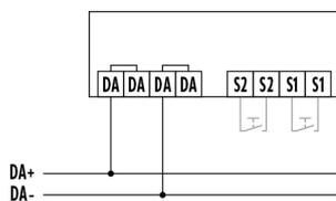
Standardbetrieb mit optionaler Ansteuerung durch Schließtaster. Leitungslänge von Taster zu Präsenzmelder maximal 30 m.
