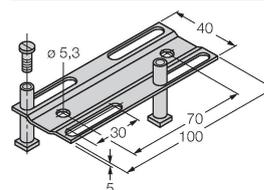
Justierschiene für Quaderbauform CK40 / CP40; Werkstoff: VA 1.4301
