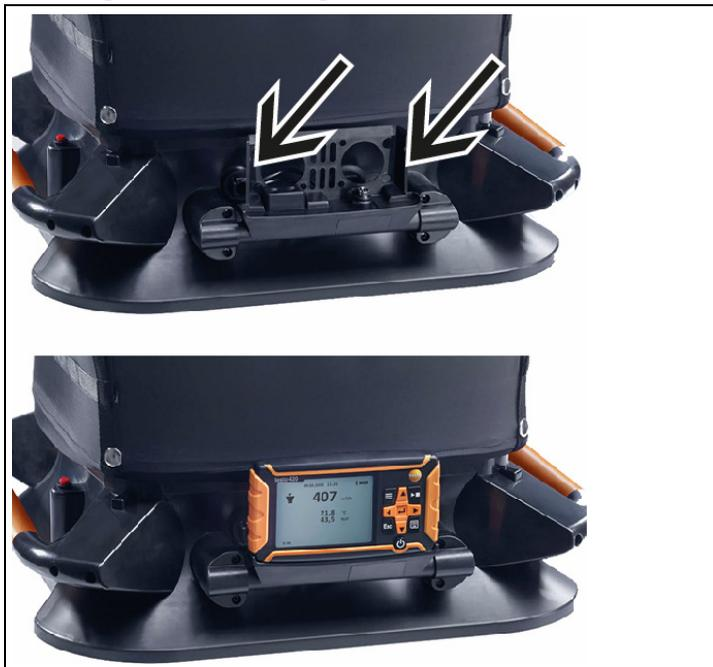
1. Stellen Sie sicher, dass das testo 420 komplett in die Geräte-Aufnahme eingeschoben ist. Achten Sie hierbei auf die Arretierung rechts und links in der Halterung.
