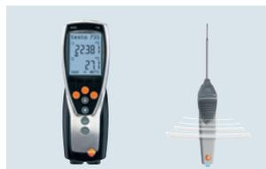
Kabellose Messung mit Funkfühler
