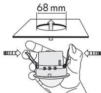
In der Decke muss zuerst eine runde Öffnung mit 68 mm Durchmesser erstellt werden. Nach dem vorschriftsgemäßen Anschluss der Kabel wird der Melder in die vorhandene Öffnung eingeführt und durch die Federklappen fixiert.
