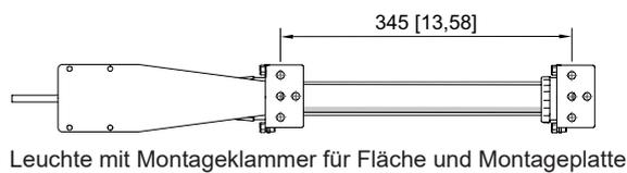
Leuchte mit Montageklammer für Fläche und Montageplatte
