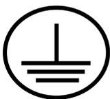
Die Schutzerdung ist eine Maßnahme, die im Fehlerfall vor gefährlicher Berührspannung und elektrischen Schlag schützt.
