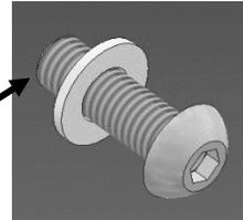
Blechteil Abdeckung-Wasseranschluss (Pos.10) mit 4 Linsenkopfschrauben (Pos.7) und 4 Polyamid Unterlegscheiben (Pos.6) befestigen.
