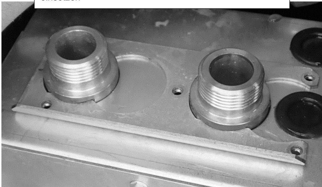
Verriegelungsblech (Pos. 3) positionieren und mit 5 Schrauben (Pos. 5) befestigen
