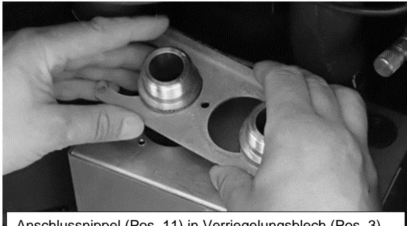
Anschlussnippel (Pos. 11) in Verriegelungsblech (Pos. 3) einsetzen
