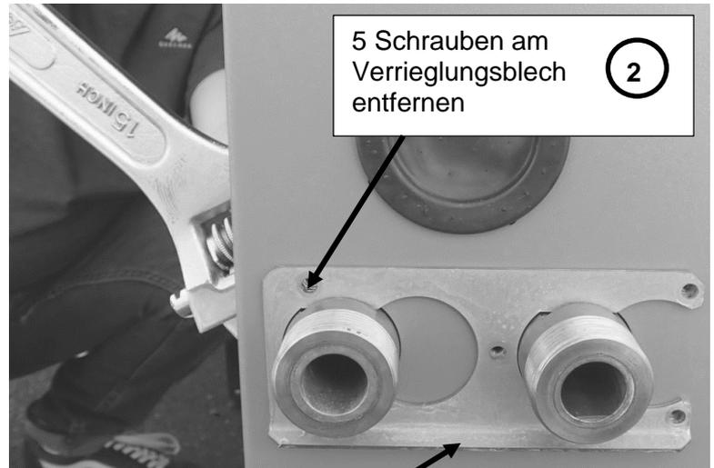
Verriegelungsblech (Pos. 3) nach links schieben und entfernen
