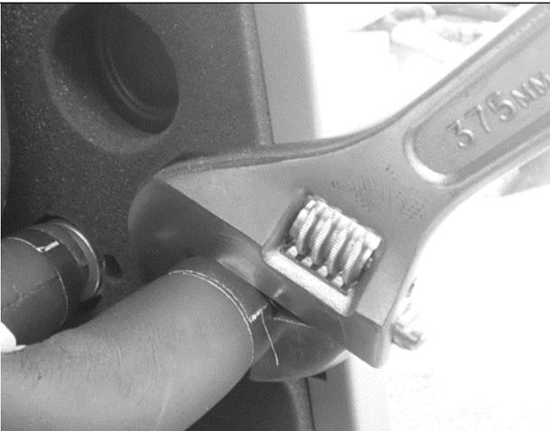
5 Schrauben am Verriegelungsblech entfernen **2**
